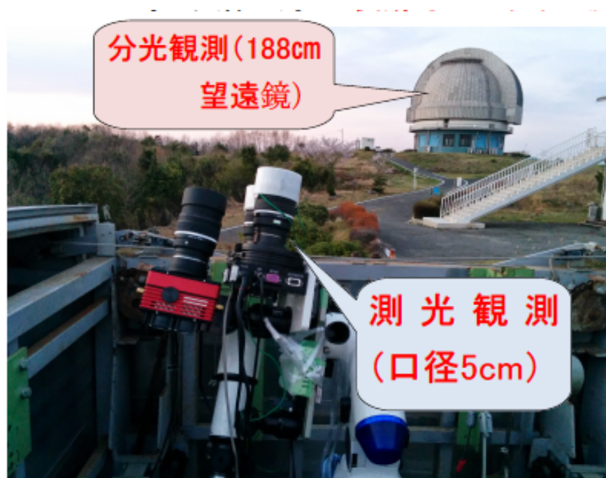
図4.岡山に設置したサーベイカメラ
