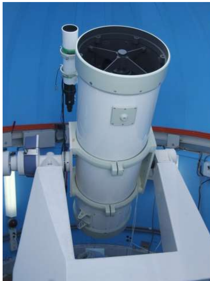
望遠鏡 タカハシ \varepsilon -350 口径355mm f=1248\text{mm} F/3.6 赤道儀 昭和機械製 フォーク式 25EF
