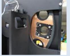
図2: 一露出型ウォラストンプリズム
