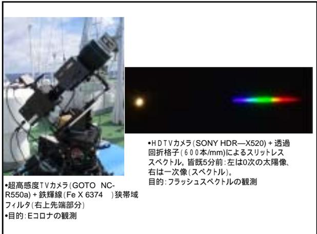
•超高感度TVカメラ(GOTO NC-R550a) + 鉄輝線(Fe X 6374)狭帯域フィルター(右上先端部分)
