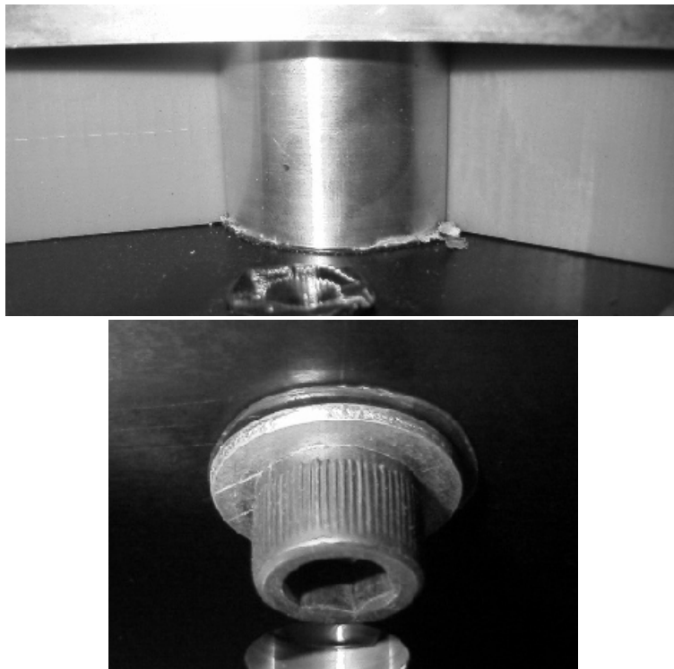
図 8.22: CISCOS の 2 枚のフランジ。手前が望遠鏡と接続される部分、奥の黒い方が CISCOS に接続される部分。中央に開いている丸い穴に CISCOS のクライオスタットがはまる。この 2 枚のフランジは 8 本の金属柱で接続され、この金属柱と黒いフランジが絶縁されている (下図)。
