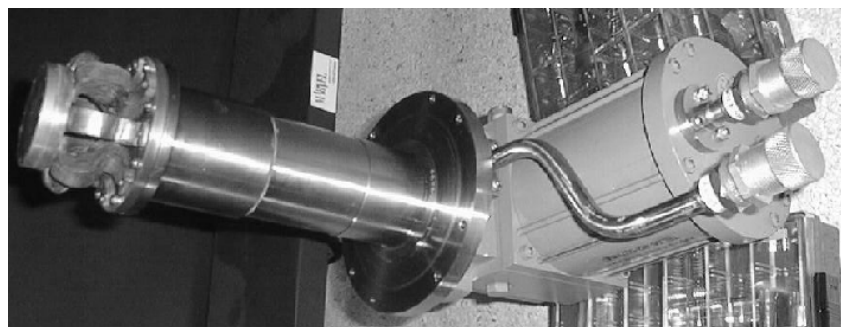
図 4.4: 取り外されたコールドヘッド。左端についているのが冷却部を結ぶ銅薄膜のストラップ。
