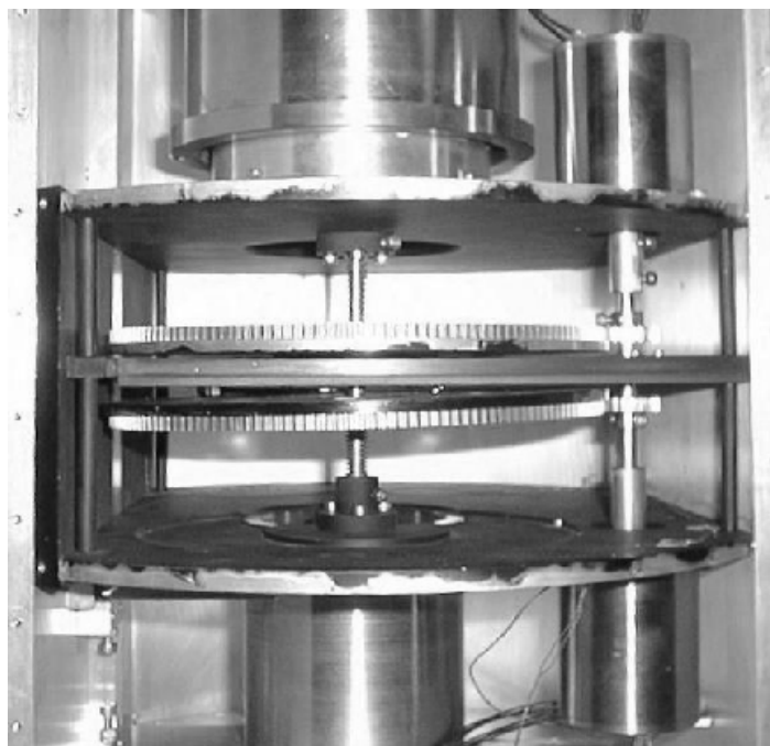
図 7.1: フィルタホイール。右側の上と下についている丸い筒が冷却モータである。
