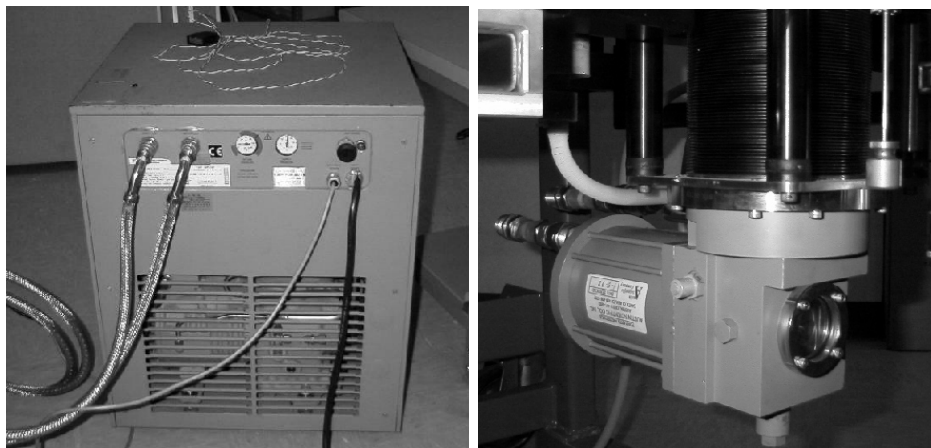
図 4.3: 冷凍機のコンプレッサ (左) と CISCO に取付けられたコールドヘッド (右)。
