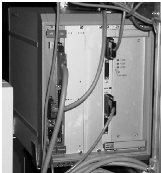
図 6.1: Messia III を搭載した VME ラック。左端に挿さっているのが VMI ボード、その隣が CIC ボードである。右端に差されているのはモータと温度計の制御を行うための RS-232C インターフェースボード。
