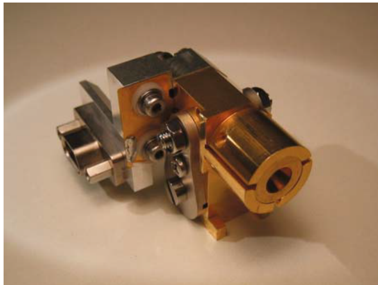
図 5.12 [ALMA の Band9 SIS ミクサー] フィードホーンが右側に、SIS ミクサーホルダーが左側にある。宇宙調査機構 (SRON) で開発された。この受信器は 610 \sim 720 [GHz] の範囲をカバーする。調整不要の DSB ミクサーである。ALMA で使用される典型的なサブミリ波 SIS ミクサーである。
