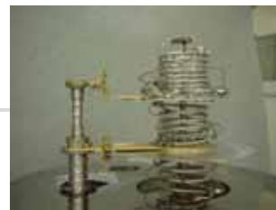
宇宙用機械式冷凍機として 世界最低温度を記録 (1.4K)
