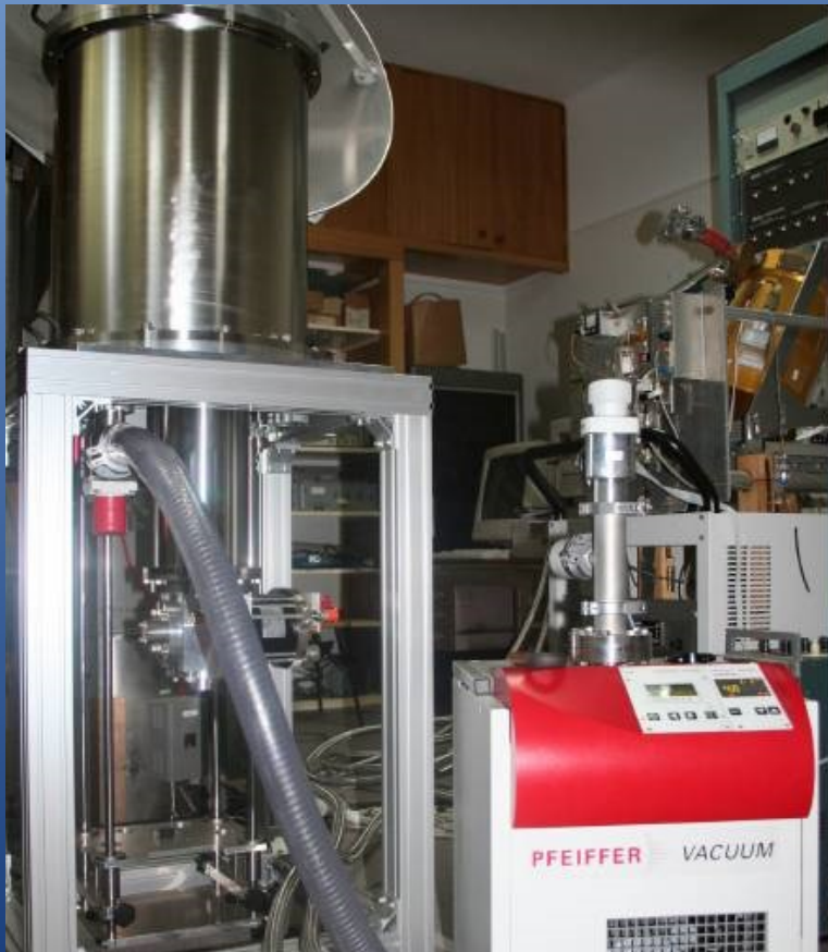
ALMA compatible cryostat (NAOJ)
