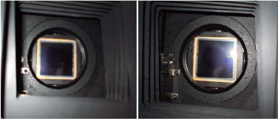
図 1: 2KCCD カメラのデュワー窓の写真 (5月31日撮影)。左右の2方向から撮影した。見えにくいですが、窓の下側の中央当たりにかすかに白い汚れがある。
