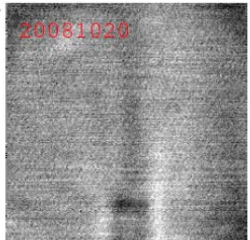
窓の汚れによるフラットの変化。20081020 のフラットを 20100602 のフラット(汚れを拭いた後)で割ったもの。
