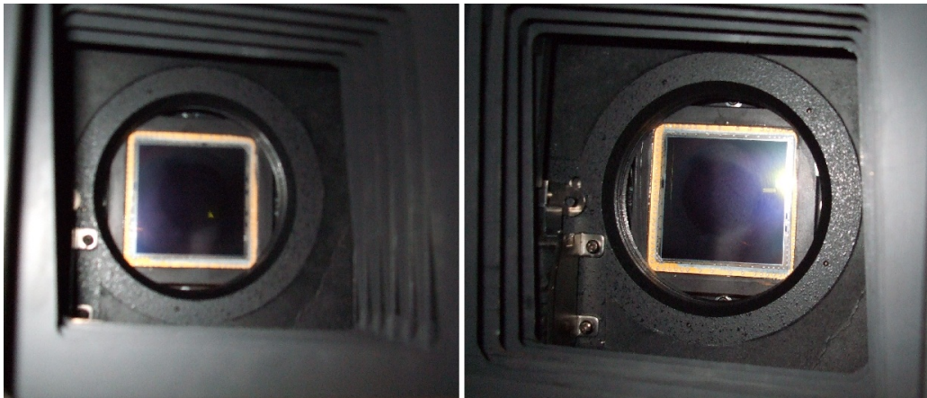
図 1: 2KCCD カメラのデューア窓の写真 (5 月 31 日撮影)。左右の 2 方向から撮影した。見えにくい、窓の下側の中央あたりにかすかに白い汚れがある。
