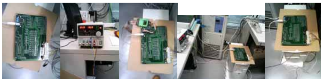
図 17 DRV ボードへのソフトウェア書き込み作業
