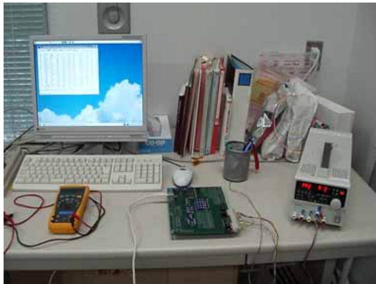
図 18 DRV ボード駆動の様子
