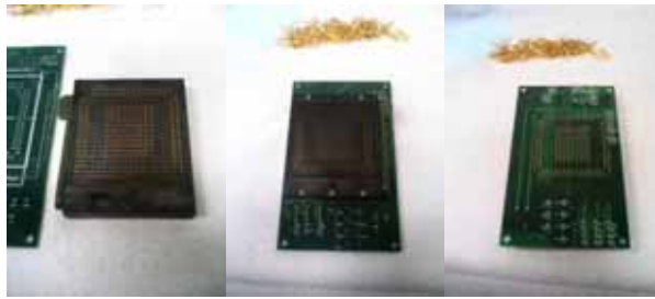
図 14 ファンアウトボードへの ZIF ソケットの実装
