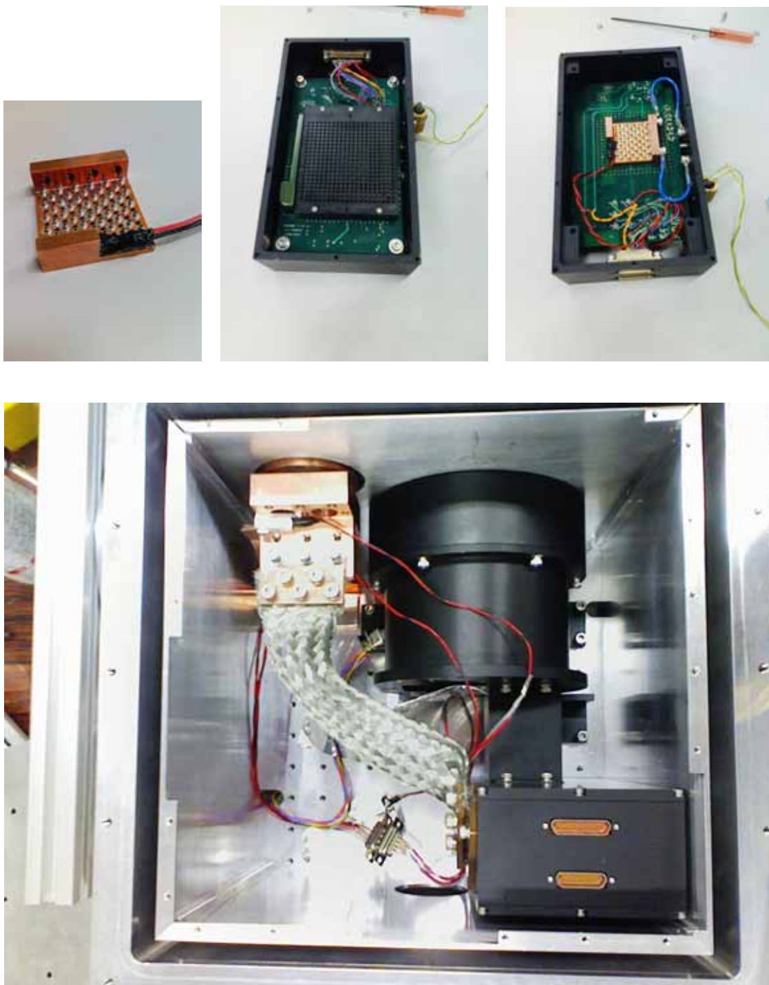
図 15 ヒートシンクと検出器ボックス
