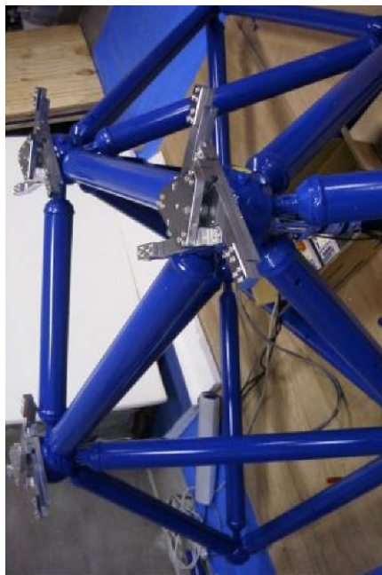
図 27: アクチュエータをトラス構造物に取りつけた写真 (217 ページ)
