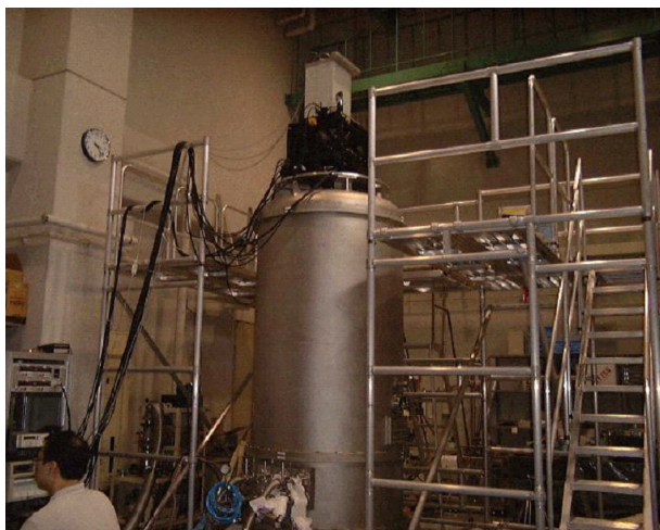
図 5.28: JAXA 宇宙科学研究本部の液体ヘリウム試験チャンバー
