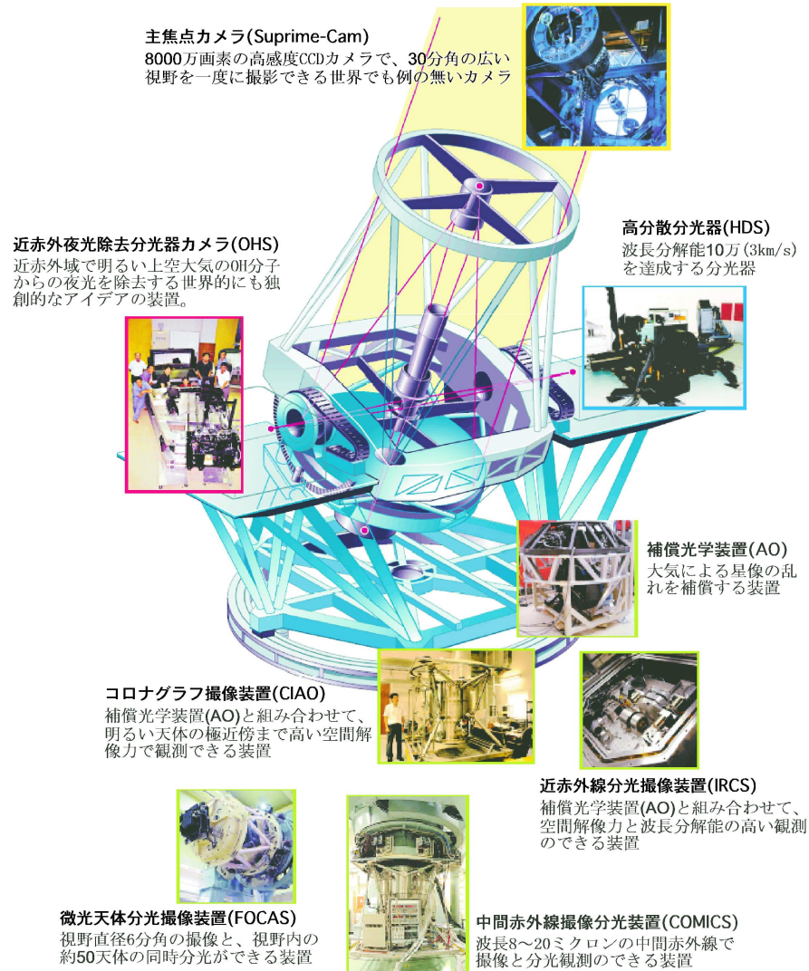
図 10: すばる望遠鏡の第一期共同利用観測装置。主焦点と2つのナスミス焦点に1つずつ。カセグレン焦点に5つ。この他にも持ち込み装置が主焦点、ナスミス、カセグレン焦点に1つずつ存在している。(47 ページ)
