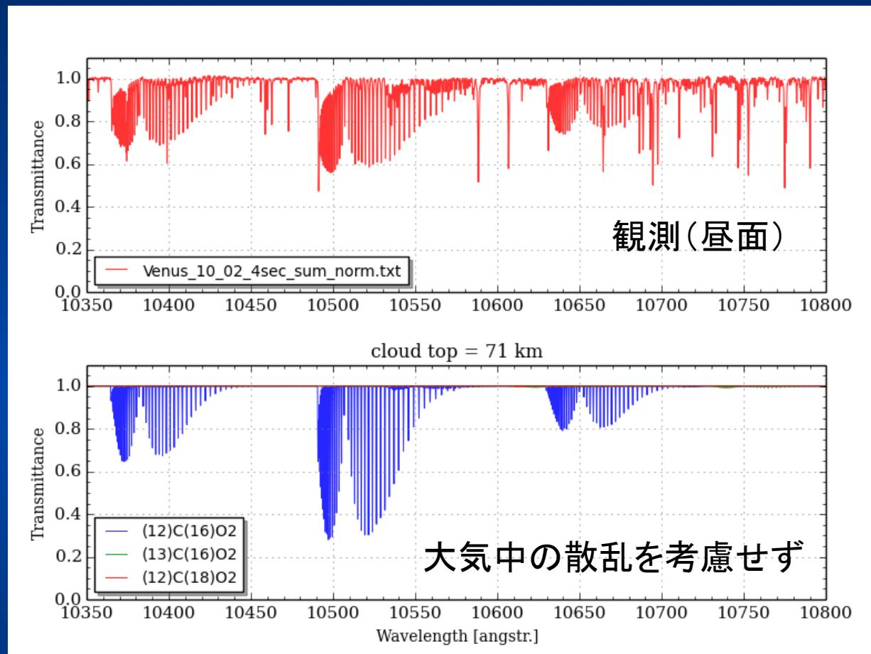
金星大気中の雲で反射した太陽光を観測している(太陽光が金星の雲に反射してから地球に届く間に通る、金星大気の成分による吸収が見える→  $\text{CO}_2$ など)
