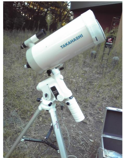
図 1 望遠鏡と架台。望遠鏡の接眼部に CCD カメラを取り付けて撮影した。
