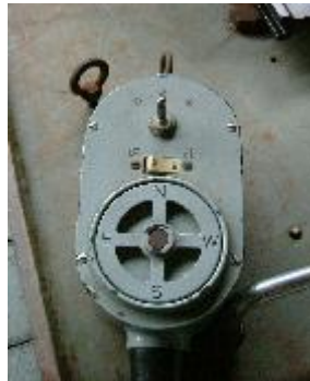
図 2: 望遠鏡のハンドセット。裏面についているスイッチで駆動速度を切り替えられるため、遅くしたときには動いていてもほとんど見た目には分からない程になるが、この状態で撮像をすると尾を引いたような形で CCD に写ってしまう。
