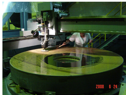
Figure 6: 現在、L-ZOS Optics 社で製作中の主鏡。有効口径 2-m で、表面精度は 1/15 \lambda (RMS)。ガラス材には Astro-Sital を用いる。2009 年春に完成予定。写真は 2008 年 6 月撮影。
