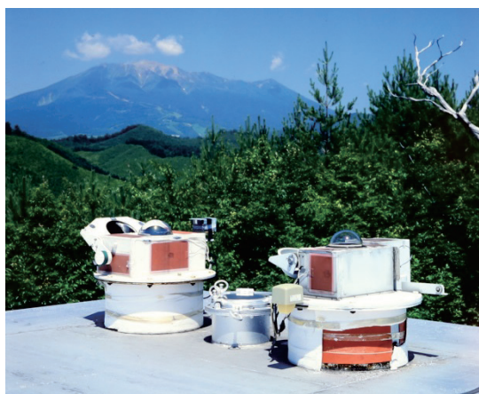
図3. 夜天光の定常観測装置。左から全天カメラ、分光器、天頂測光器。背景に木曾御岳山を望む。
