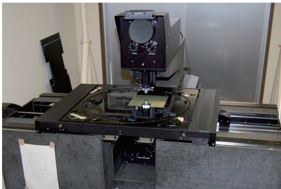
乾板の回転調整を行えるように改造した載物台(三鷹光器製)
