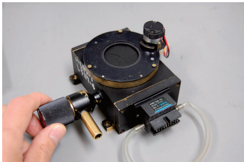
CCD と冷却器： 右側、手に持っているのが CCD-TC215 で、中央白い部分が冷却部、ガラス製のフィンガーに CCD 用の信号線が巻かれている。窒素ガス冷却部とエレキコネクタが一体化されている。
