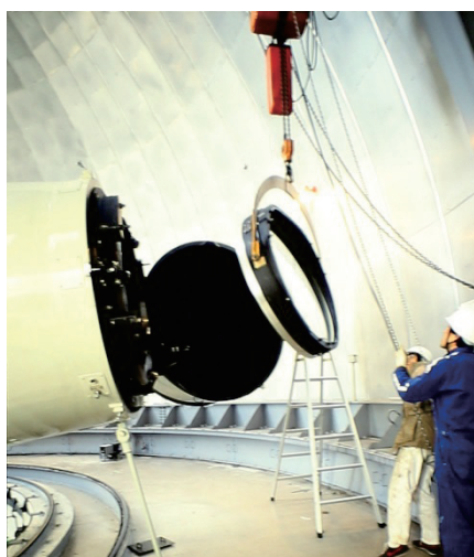
プリズム装填作業: 総重量約 400kg のプリズムユニットは、ドーム付属のクレーンで吊り上げ、補正板手前のプリズム回転リングに取り付ける。リングは90° 刻みで回転させることが可能。
